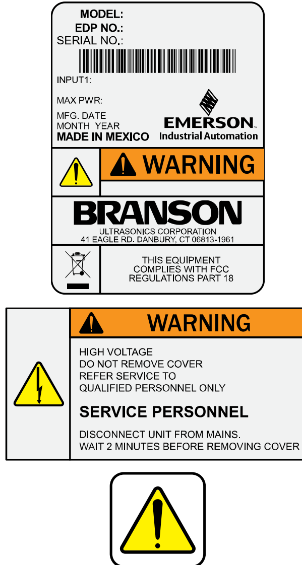
図 1.1 DCX F EIP パワーサプライに貼付されている安全に関するラベル
